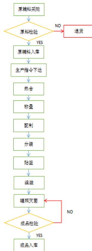
图 2 转运培养基生产工艺流程图
